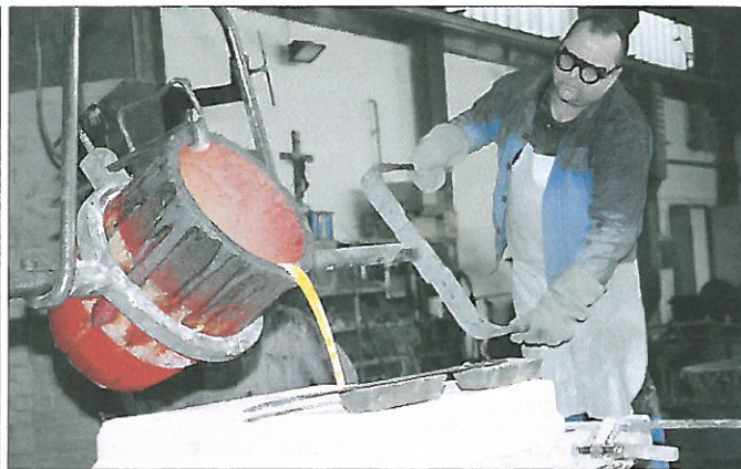
Ein Mitarbeiter der Glocken- und Kunstgießerei gießt die flüssige Bronze in eine Form - daraus entsteht der Oberkörper einer Figur. Anschließend erklärt Juniorchef Johann Gugg (Bild rechts), was es mit dem Rohguss auf sich hat.
